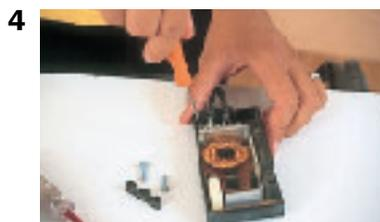
4. Dévisser les vis des bornes et sortir les fils.
